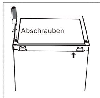
2. Entfernen Sie die obere Abdeckung und den Thermostatregler; legen Sie beide Teile beiseite.
