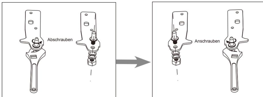
6. Befestigen Sie die Halterung, indem Sie den Stift des unteren Scharniers installieren. Installieren Sie die beiden Nivellierfüße.
