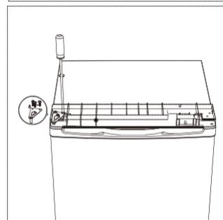
8. Bringen Sie die obere Abdeckung an und sichern Sie diese mit den 2 Schrauben an der Rückseite.
