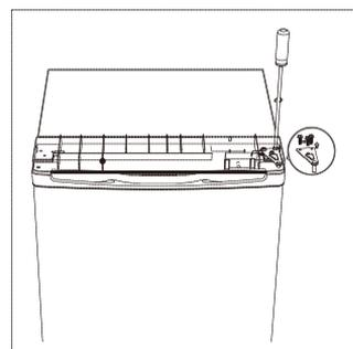
4. Schrauben Sie das untere Scharnier ab. Entfernen Sie dann die verstellbaren Füße an beiden Seiten.
