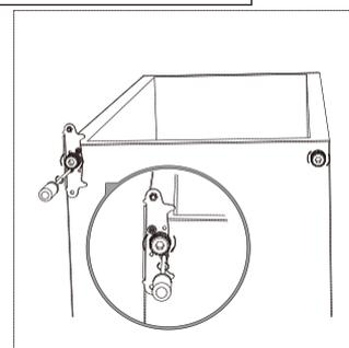
7. Installieren Sie dann wieder die Tür. Vergewissern Sie sich vor dem Festziehen des oberen Scharniers, dass die Tür horizontal und vertikal so ausgerichtet ist, dass die Dichtungen an allen Seiten gut verschlossen sind.
